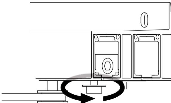
Tendre les courroies à l'aide des vis de réglage latérales. Figer le réglage à l'aide de la vis sous la poulie
