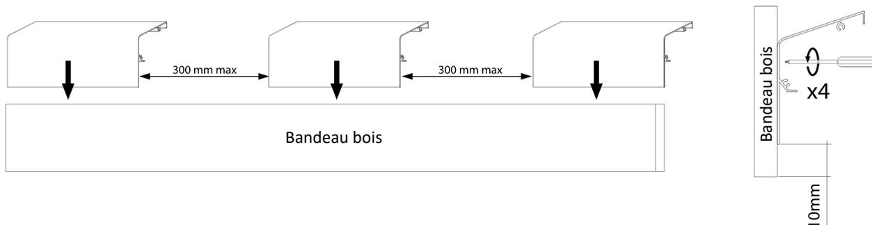
Emboîter le capot, percer le et les supports de rail (forêt Ø 3.5) afin de les fixer avec les vis fournies (3.9x13 - ref 657535)
