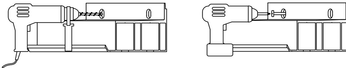
Placer le rail dans les deux supports fixés tout en glissant les autres supports sur le rail
