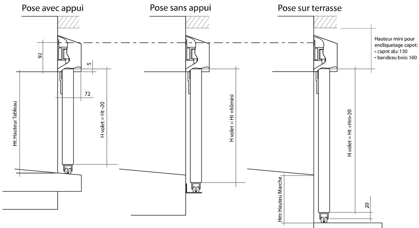
Attention au positionnement des supports de rails, bien prendre en compte les différentes variables (voir point 3-Mise en place du rail haut) avant de débuter la pose.
