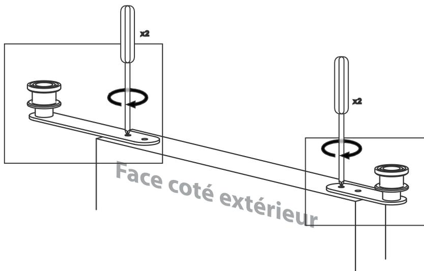
Fixer la grande et la petite poulie à l'aide des vis (3.5x25 pour bois et pvc) ou des rivets (4x13 brut ref : 987 pour alu) afin d'obtenir la même composition que le schéma ci-dessous :
