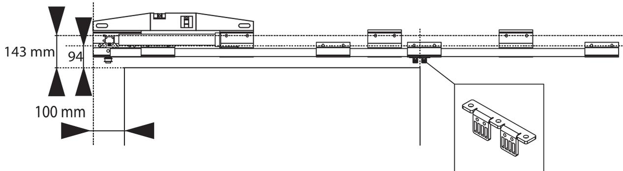
Percer puis fixer le kit motorisé (Visserie non fournie et à adapter au support conformément au DTU 34.4)
