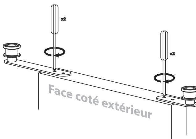
Fixer la grande et la petite poulie à l'aide des vis (4x30 pour bois et pvc) ou des rivets (4x13 pour alu ref 987) afin d'obtenir la même composition que le schéma ci-dessous :
