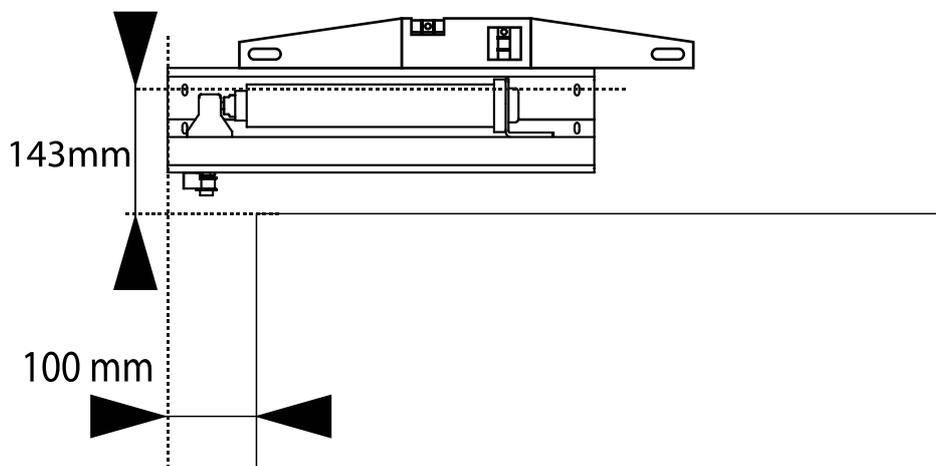
Percer puis fixer le kit motorisé (Visserie non fournie et à adapter au support conformément au DTU 34.4)
