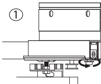
Figier le réglage à l'aide de la vis sous la poulie
