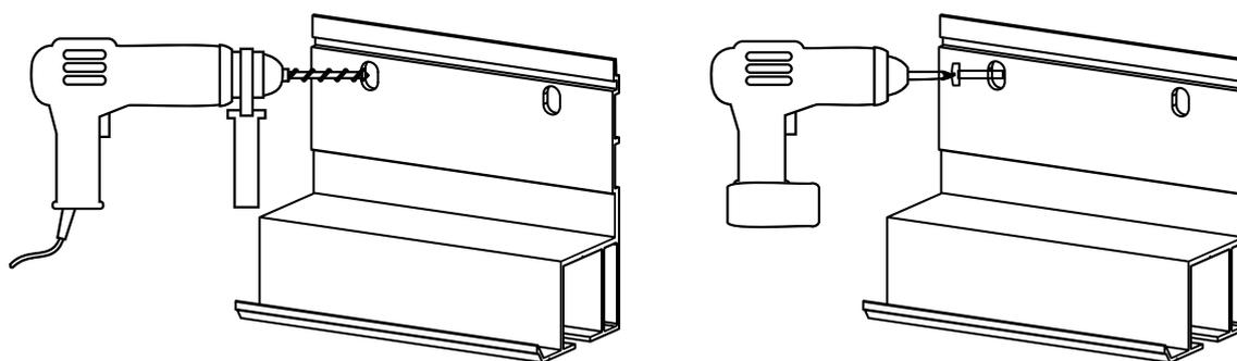
Emboîter et maintenir le rail dans le support du kit motorisé. Glisser les supports de rail sur le rail. Mettre à niveau le support de rail opposé du moteur. Répartir les supports sur le rail avant de les fixer.
