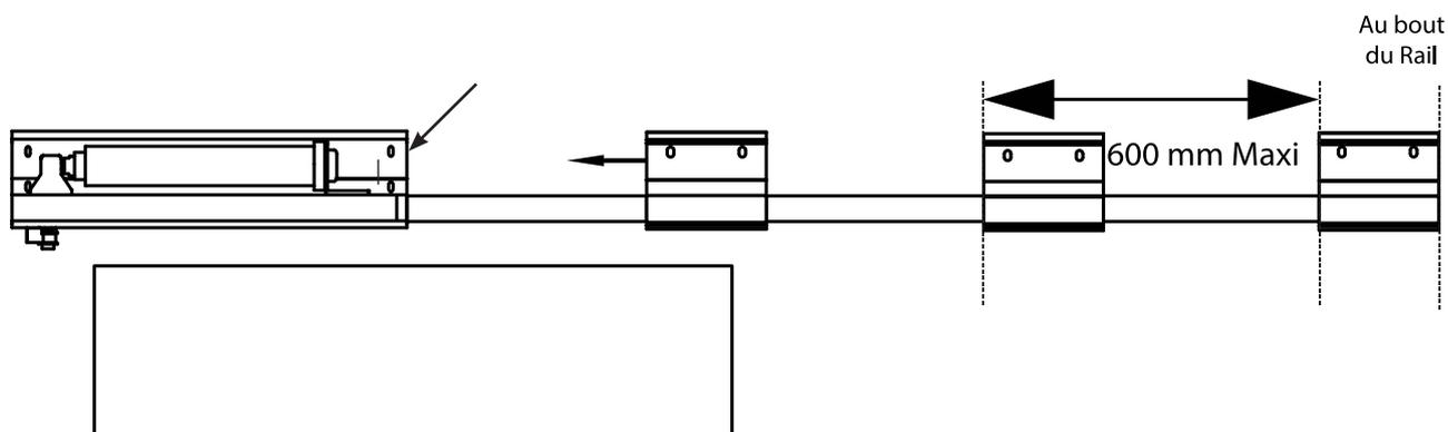
Percer les supports et les rail (forêt  $\varnothing$  3.5) puis fixer à l'aide des vis fournies (3.9x13 - ref 657535), perçage par-dessous ou par-dessus selon longueur forêt disponible et encombrement, vissage par-dessous.
