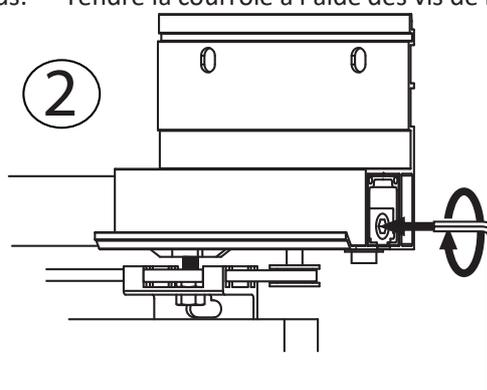
Venir mettre le bloc courroie en appuie. Et serrer la vis.
