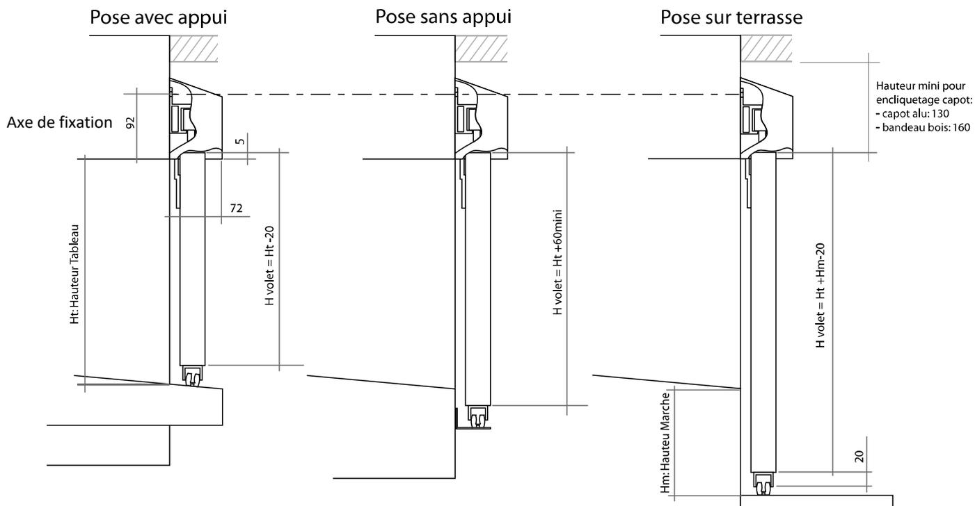
Attention au positionnement des supports de rails, bien prendre en compte les différentes variables (voir point 3-Mise en place du rail haut) avant de débuter la pose.
