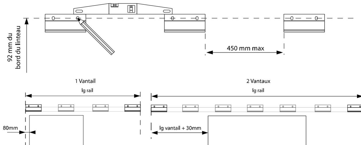
Percer puis fixer les deux supports de rail des extrémités. (Visserie non fournie et à adapter au support conformément au DTU 34.4)
