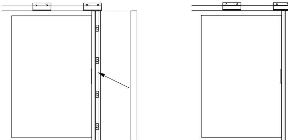
! Si nécessaire, ajuster la butée de fin course à la fermeture pour éviter une fermeture brusque sur le montant gâche.
