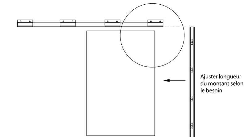
Positionner le montant à 15 mm du bord de l'ouverture, vérifier son niveau puis percer et fixer (Visserie non fournie et à adapter au support conformément au DTU 34.4)
