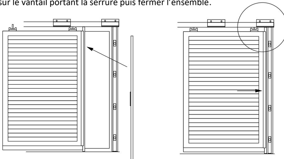
Tracer sur le montant gâche la position du profil en U lorsque celui-ci est plaqué sur les brosses du couvre-joint, puis percer et visser avec les vis autoperceuse fournies (4821017)
