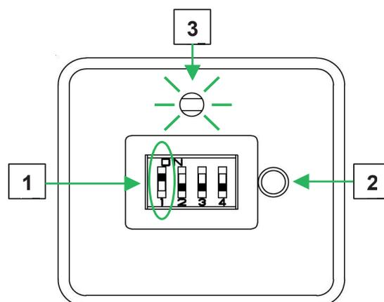
Les volets se déplacent en butée d'ouverture puis en butée de fermeture pour mémoriser la distance de déplacement : ses mouvements s'effectuent en vitesse lente.
