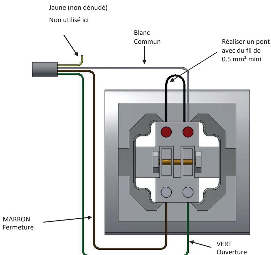
Appuyer sur l'un des boutons et dans un même temps insérer le fil dans l'une des deux cavités situées sous le bouton. Relâcher le bouton, le fil est alors pincé dans la cavité. Vérifier en tirant légèrement sur ce dernier. Répéter la manipulation pour chacun des fils.
